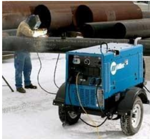
شكل رقم ٣٦: ماكينة لحام تعمل بمولد كهربى مدمج بها
