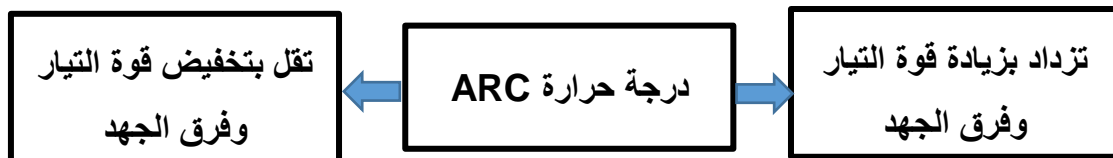
شكل رقم ٢٢: العلاقة بين درجة حرارة القوس الكهربى ARC وقوة التيار وفرق الجهد الكهربى
